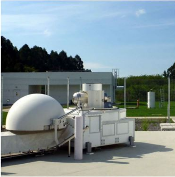
telescopio óptico con 50cm apertura y sistema láser para medir distancias
