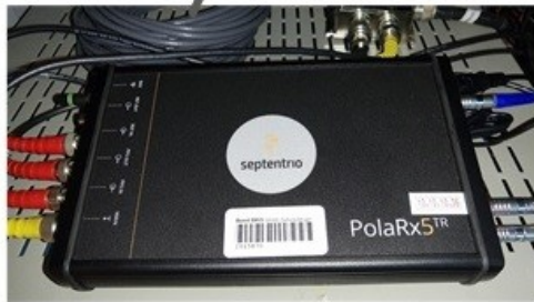
escala local vinculada con UT por reloj de GNSS 10^{-9}
