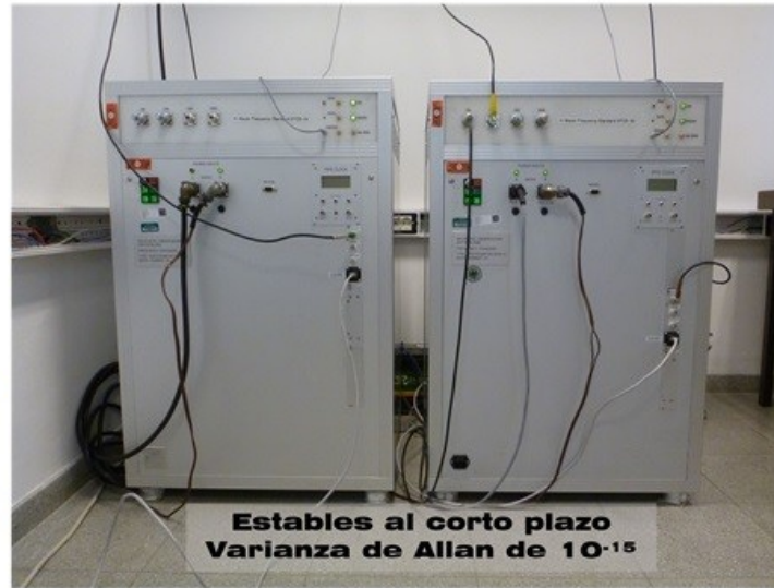
Estables al corto plazo Varianza de Allan de 10^{-15} Maser de Hidrógeno para VLBI y SLR 10^{-15}
