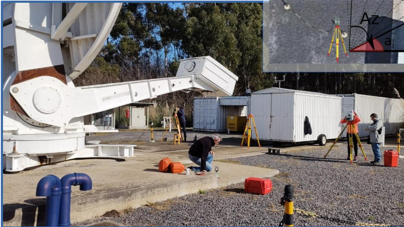
El telescopio fue rotado alrededor de su eje de acimut cada 40° y se midió la posición de la marca colocada respecto de las 2 estaciones. Se obtuvieron 9 posiciones diferentes.
